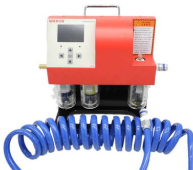
扭矩控制器,配8米弹簧管
