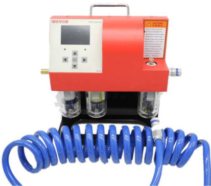
扭矩控制器,配8米弹簧管
