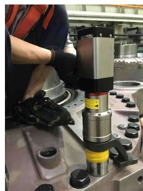
SVW-40用于重型齿轮箱螺栓装配
