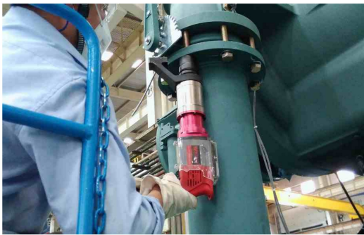
ESW-12用于大型制冷设备螺栓装配
