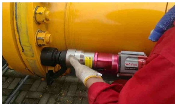
ETW-26S用于西气东输管道螺栓拆装
