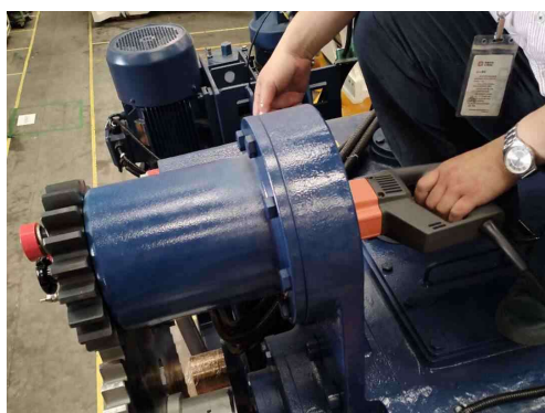
PCW-25用于风电齿轮箱盘车
