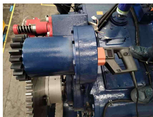
PCW-25用于风电齿轮箱盘车
